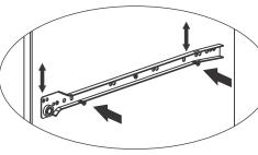
Ziehen Sie die Šu§eren Schrauben an den verstellbaren Lšchern der Schieber fest (jedoch nicht vollstŠndig festziehen). Gleichen Sie die Schieber nach Bedarf aus und ziehen Sie dann die Schrauben vollstŠndig an.
