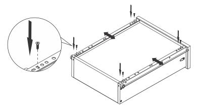
Verwemdem Sie nun für die Zentralschraube (Schiene Mitte) das freire, nicht vorgebohrte Loch für die dritte Befestigung und ist vollbracht!
