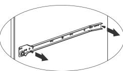
Entfernen Sie die Schrauben am Šu§eren Rand der Schieber, die an der Seite des MšbelstŸcks befestigt sind. Nun einfach die mittlere Schraube Išsen.
