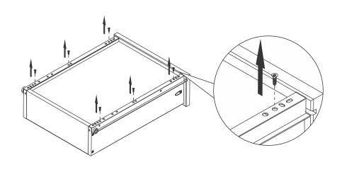
Zur Neu Befestigung der Schienen benutzen Sie die «querliegenden» Langlöcher vorne und hinten an den Schienen. Achten Sie dabei darauf, dass die Schubladenführungsschiene vorne an der Schubladenfront anliegt bzw. anstößt. Drücken Sie die Schiene fest an die Schubleadenseitenwange und die Schrauben anschließ
